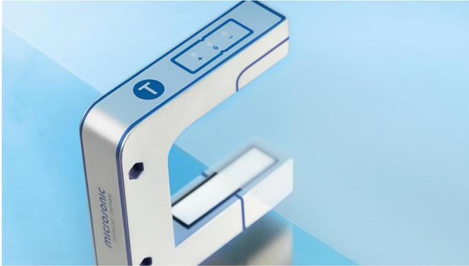
*Mit einer Gabelweite von nur 30 mm, bzw. 60 mm und einer Tiefe von 33 mm, bzw. 73 mm ist er sehr kompakt gebaut. Der Arbeitsbereich von 12 mm, bzw. 40 mm und die hohe Genauigkeit von 0,1 mm erlauben einen vielfältigen Einsatz.*
